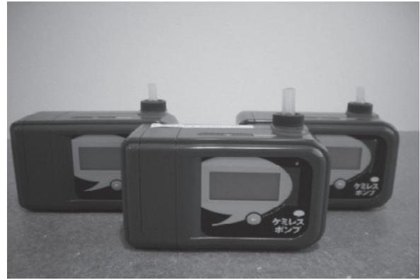
図3 ケミレスポンプ：捕集管を差し込みスタートボタンを押すだけで容易に空気捕集ができる簡易型ポンプ
