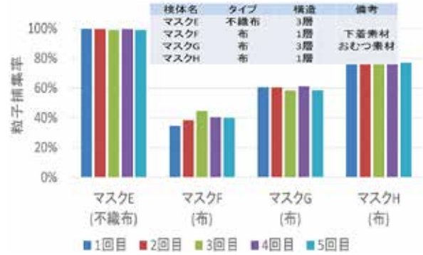
図4 PFE試験 (JIS T9001) の試験事例 (各種マスクの新型コロナウイルスの模擬粒子 (PSL 粒子) での捕集性能 原図)
