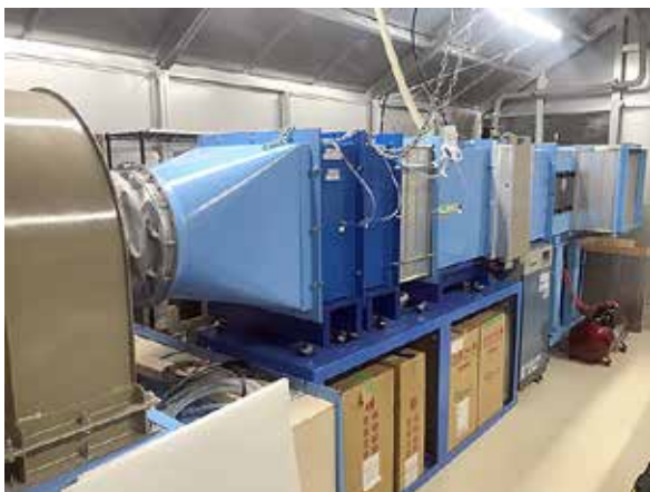
写真2 空調換気用フィルタ試験装置 (HEPA・中高性能用試験装置) (ビルの空調換気に使用されるエアフィルタは、大型で縦 (61cm) × 横 (61cm) × 厚 (~30cm 程度) (暮らしの科学研究所)
