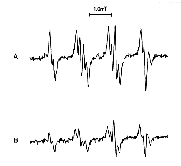
図1 O_2\cdot^- とDMPOの反応で生成する付加化合物(DMPO-OOH)のESRスペクトル(A)とCu(I)-MTsによる阻害効果(B)
