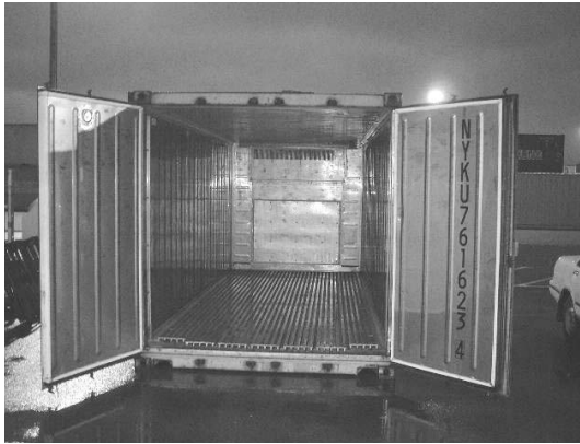
図1 実験に使ったコンテナ 5.5m(長さ)×2.3m(幅)×2.2m(高さ)
