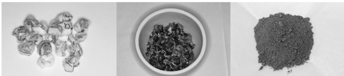
図3 乳歯 乾燥後 (左) 灰化後 (中) 粉末試料 (右)
